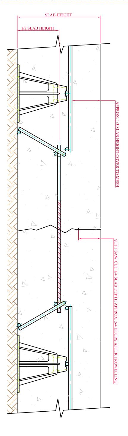
DANLEY PD<sup>3</sup> DOWEL CRADLE<sup>TM</sup> JOINT (PD<sup>3</sup>.DJ AS NOTED ON DRAWING)
